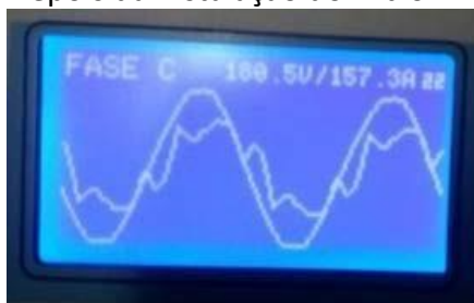
Depois da Instalação do Filtro
