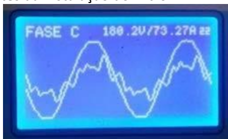
Antes da Instalação do Filtro
