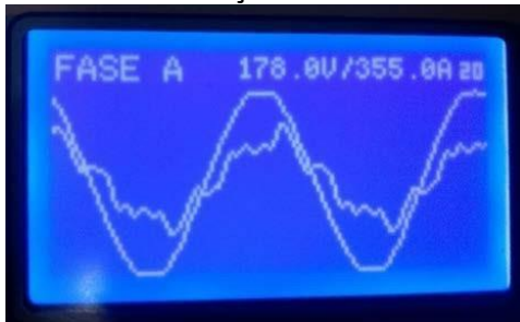
Antes da Instalação do Filtro:
