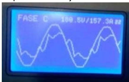
Depois da Instalação do Filtro
