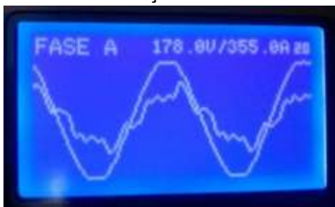
Antes da Instalação do Filtro:
